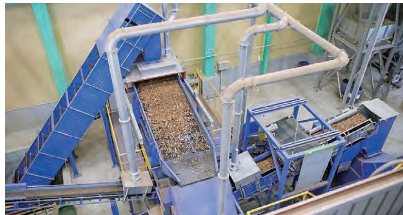
木くずは製紙原料や木質バイオマス原料として再利用
